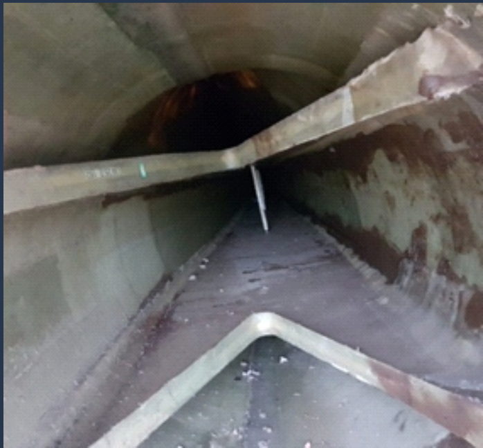
Rys. 1. Przykładowe zdjęcie budowy wewnętrznej łopaty wiatraka
