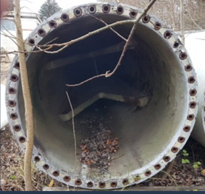
Rys. 2. Przykładowe zdjęcie przekroju poprzecznego łopaty wiatraka
