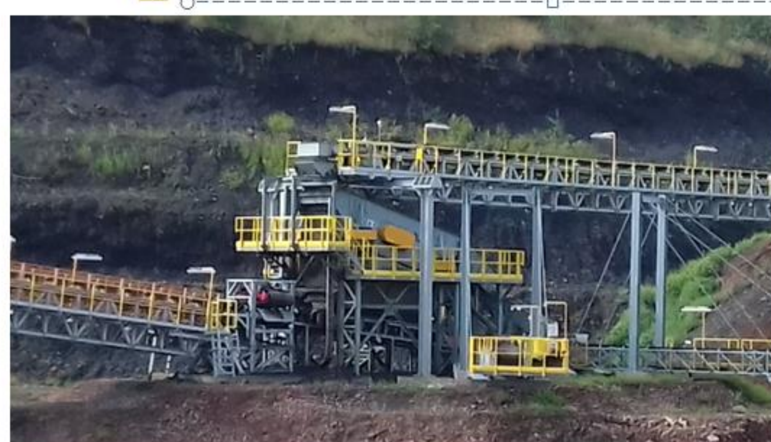
Dostawa przesiewacza PWK1 – 8K – 2,4 x 7,0 z przeznaczeniem do klasyfikacji odpadów komunalnych
