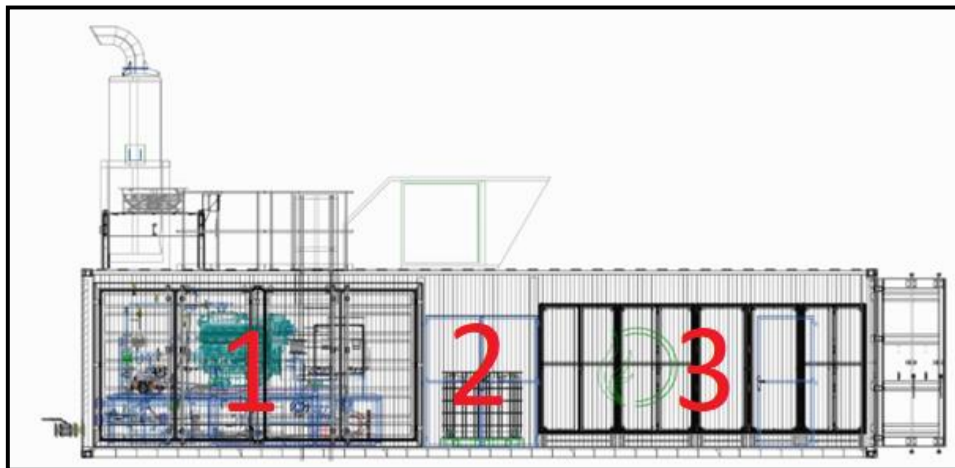
Rysunek 1. Hybrydowy Układ Kogeneracyjny w podwyższonym kontenerze (High Cube) 40' z trzema przedziałami 1) Przedział silnika; 2) Przedział paliwowy; 3) Przedział automatyki i wyprowadzania mocy.
