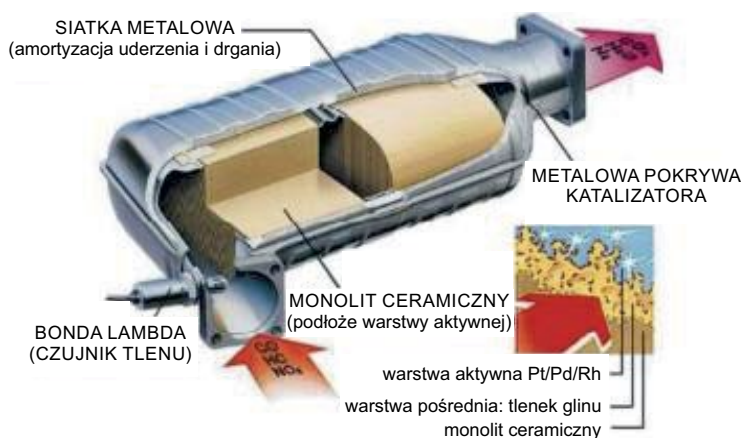
Rys. 1. Schemat budowy katalizatora trójfunkcyjnego
