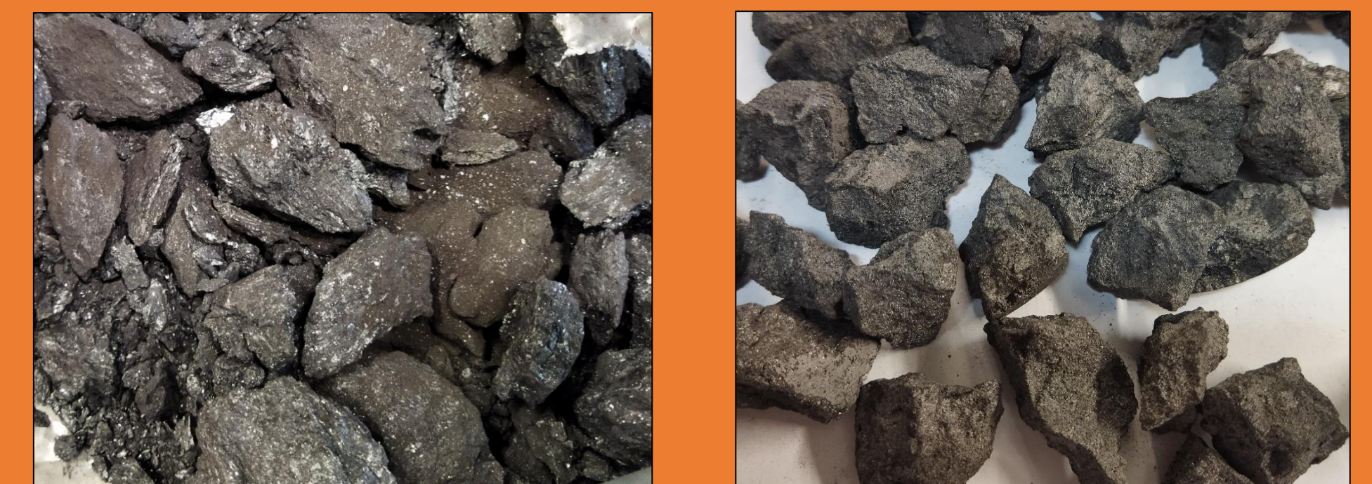
Fig. 3 – Mieszanka węgla koksowego (zdj. lewe) oraz gotowy produkt – koks (zdj. prawe)
