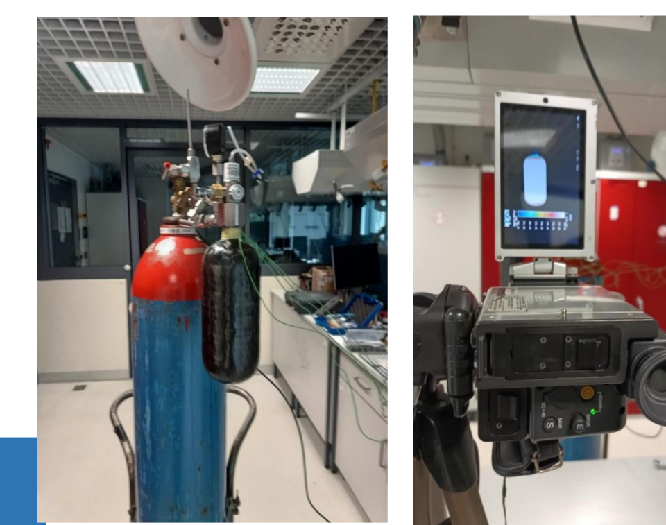
Zdjęcie stanowiska badawczego laboratoryjnego do badania przepuszczalności materiałów, z których wytworzony został liner zbiornika
