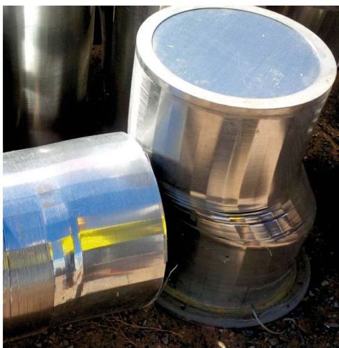
Rys. 22. Uszkodzony filtr kolumny SNK
