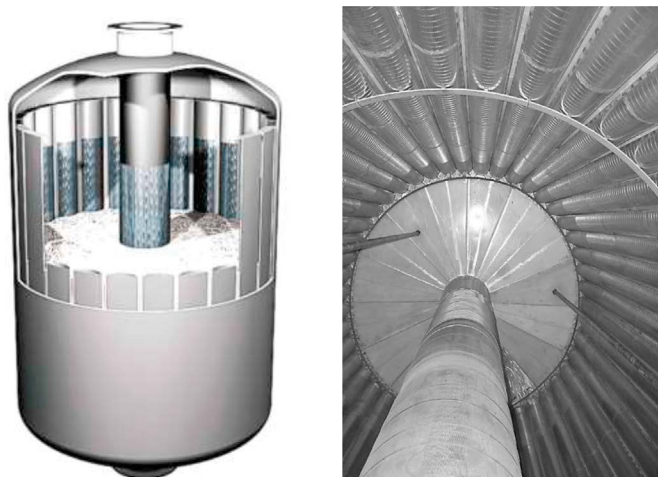
Rys. 18. Reaktory do reformingu ropy z zabudowanymi sitami szczelinowymi
