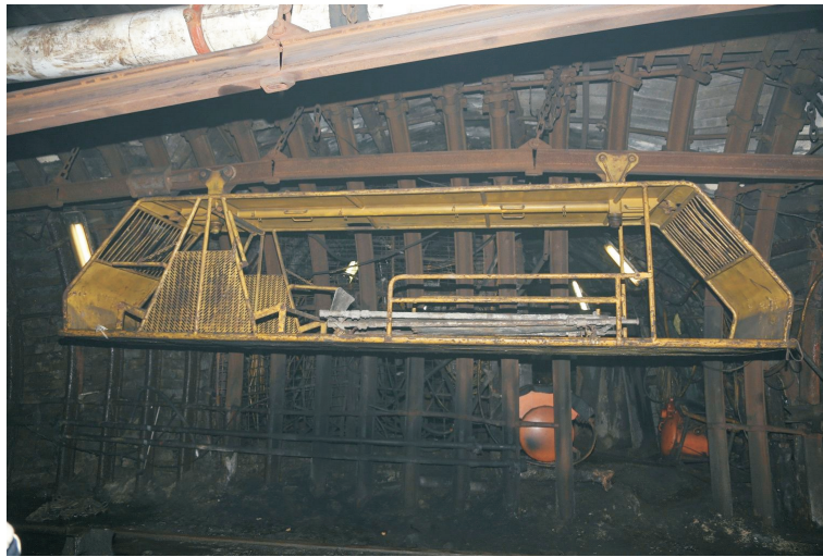
Rys. 1. Platforma sanitarna kolejki podwieszanej
