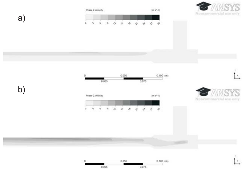
Rys. 7. Prędkość paliwa w przekroju pionowym strumienicy dla analizowanych przypadków a) prędkość 5 m/s, b) prędkość 30 m/s
