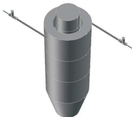
Rys. 4. Geometria modelu obliczeniowego przedpaleniska cyklonowego wraz z zabudowanymi strumienicami
