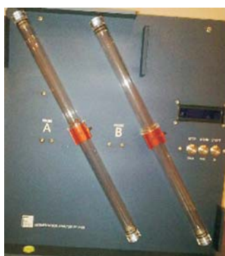
Rys. 5. Porównanie stabilności struktury suspensji węglowo-wodnych oznaczanych na aparacie Sedimentation Analyzer RF-3000
