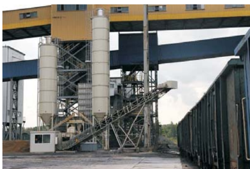
Fot. 7. Instalacja do produkcji mieszanek kruszywowo-popiołowych w ZG Sobieski w Jaworznie (opracowanie własne)
