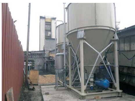
Fot. 9. Instalacja do podawania popiołów do kruszywa w ZG Janina (opracowanie własne)
