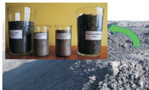
Fot. 5. Wytwarzanie kruszyw ze skały płonnej (opracowanie własne)
