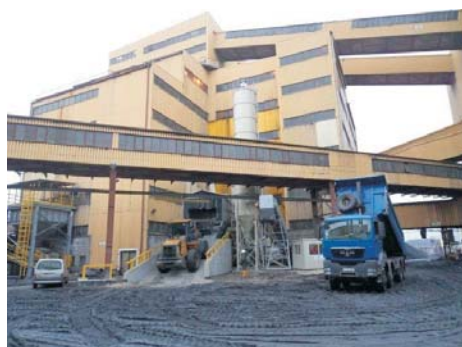
Fot. 8. Instalacja do produkcji mieszanek kruszywowo-popiołowych w ZG Janina w Libiążu (opracowanie własne)
