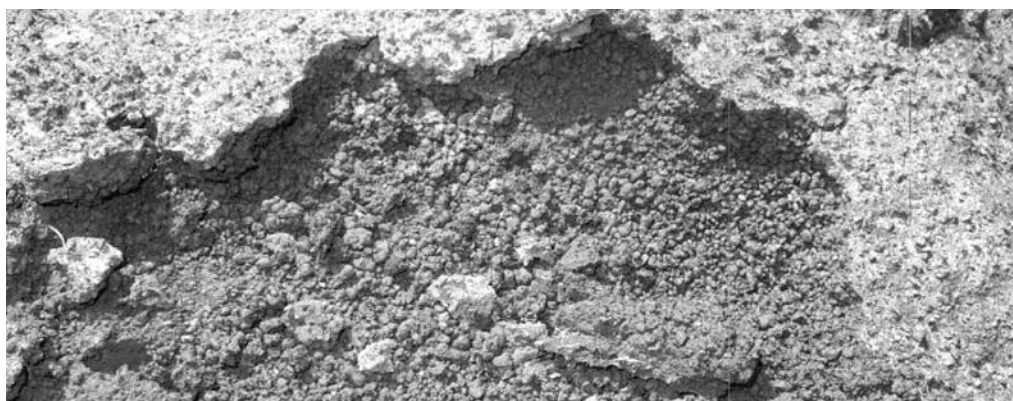
Rys. 4. Stan powierzchni zwałowiska po okresie rocznym składowania aglomeratu
