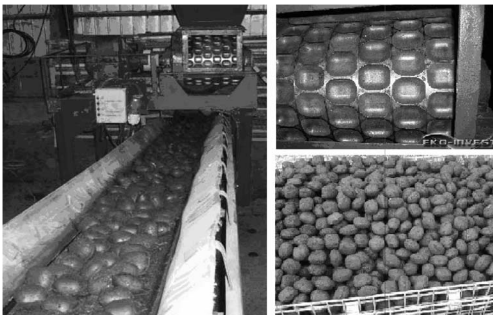
Rys. 4. Wygląd brykietciarki dwuwalcowej, walca i uzyskiwanych brykietów
