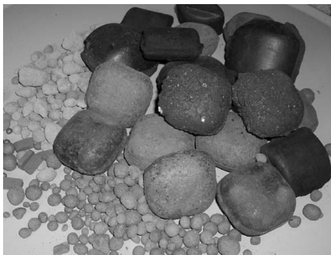
Rys. 5. Przykłady scalonych surowców i odpadów pylistych i drobnoziarnistych
